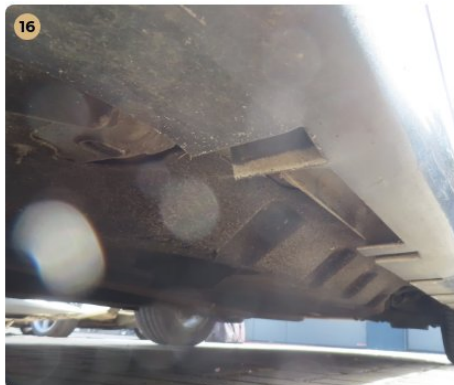
16 Utascella és gyűrődő zónák A küszöbökön javításra utaló nyomok nem észlelhetők.
