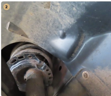
✓ Futómű A lengéscsillapítón olajfolyás nem észlelhető.
