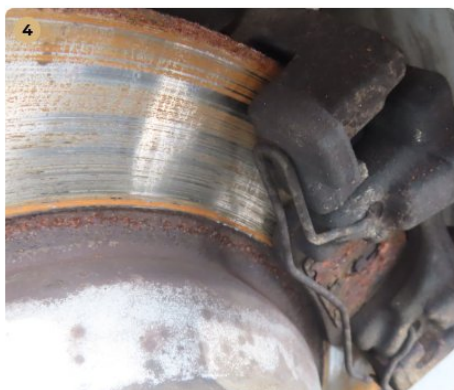
⚠ Fékrendszer féktárcsák korrodáltak
