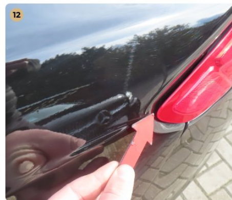
⚠ Külső karosszéria elemek A karosszéria elemek közötti hézagok nem megfelelőek (hézagos).
