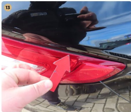
13 Külső karosszéria elemek A karosszéria elemek közötti hézagok nem megfelelőek (hézagos).
