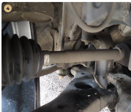
4 Futómű A gumiharangokon szakadás, repedés nem látható.
