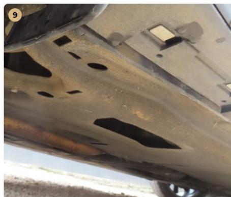
9 Utascella és gyűrődő zónák A küszöbökön javításra utaló nyomok nem észlelhetők.
