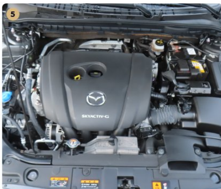
5 Motor Motortérben olajfolyás nem látható.
