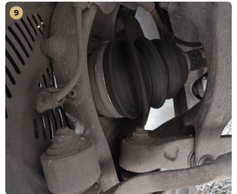
9 Futómű A féltengelyen zsíros / olajos kicsapódás nem látható.
