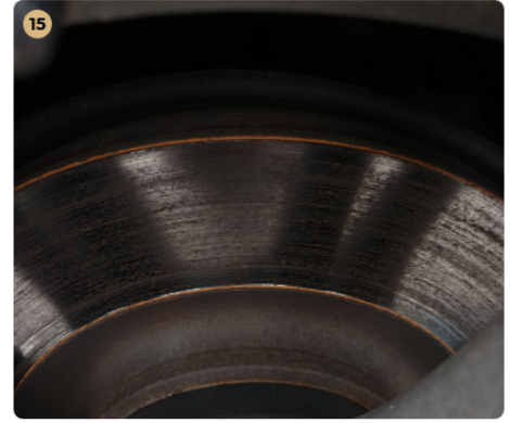
15 Féktárcsa A féktárcsán kezdődő vallasodás található.
