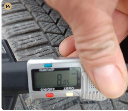
14 Gumiabroncsok A gumiabroncsok odalfala nem repedezett, gumi mélység megfelelő.
