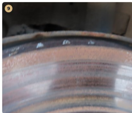
! Féktrendszer Hátsó féktárcsák korrodáltak.
