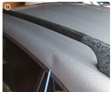
12 Külső karosszéria elemek Bal oldali kereten horpadás van.
