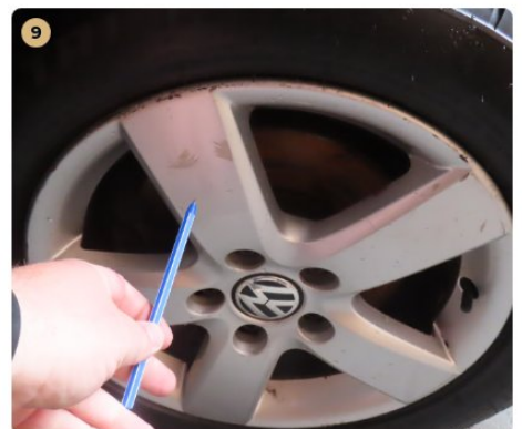
9 Felnik Könnyűfém felnin patkázás nyomai láthatóak.
