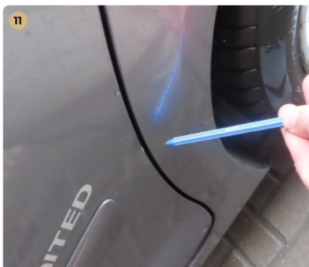
11 Külső karosszéria elemek Az autó használatából eredő apró kavicsfelverődések, hajszál karcok láthatóak.
