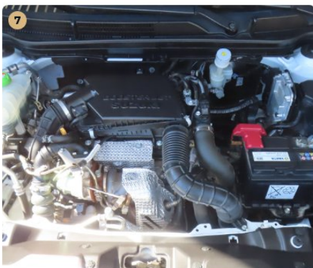
✓ Motor Motortérben olajfolyás nem látható.
