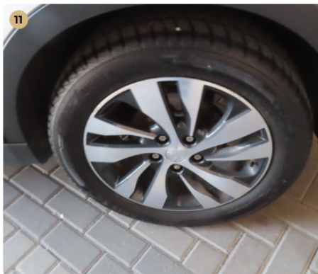
✓ Felnik Könyűfém felnin patkázás nyomai nem láthatóak.
