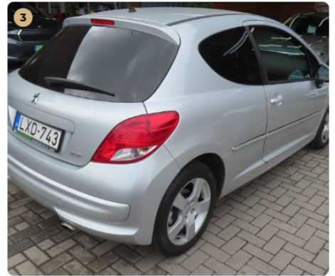
3 Külső karosszéria elemek A karosszéria elemek közötti hézagok megfelelőek.
