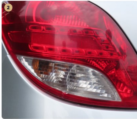
2 Világítás Bal hátsó lámpa búra repedt.
