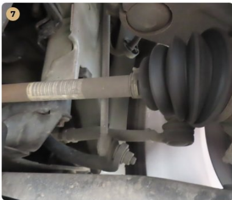
7 Futómű A lengéscsillapítón olajfolyás nem észlelhető.
