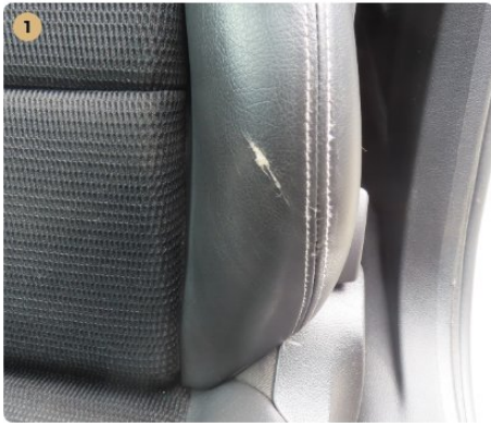
1 Kárpitozás és belső burkolatok Vezető oldali ülés oldal támasza szakadt.
