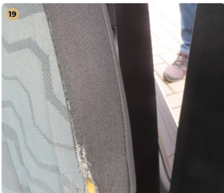
! Kárpitozás és belső burkolatok Vezető ülés szakadt.
