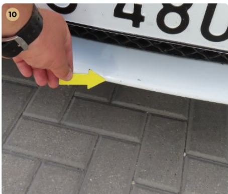
10 Külső karosszéria elemek Az autó használatából eredő apró kavicsfelverődések, hajszál karcok láthatóak.
