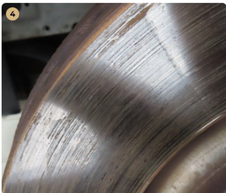
4 Fékrendszer A féktárcsán kezdődő vállasodás található.
