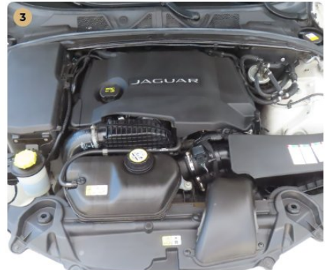
3 Motor A hűtőfolyadék szintje megfelelő.
