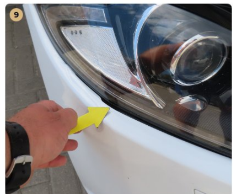
9 Külső karosszéria elemek Első vészháritó és az első fényszórók között a hézag nem megfelelő.
