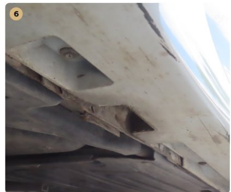
6 Utascella és gyűrődő zónák A küszöbökön javításra utaló nyomok nem észlelhetők.
