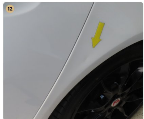
12 Külső karosszéria elemek Bal hátsó sárvédőn horpadás van.
