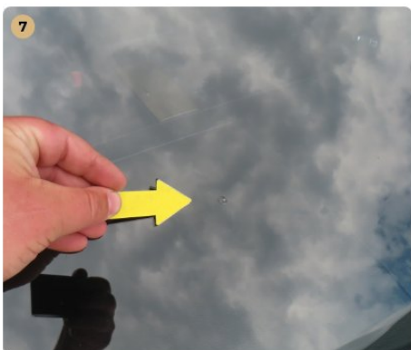
7 Szélvédők, üvegek első szélvédőn kavics sérülések vannak.
