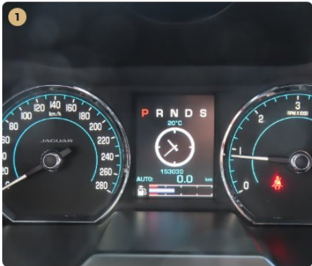
1 Híbakód kiolvasása Az autó beindítását követően kontrollámpa a műszerfalon nem világít.
