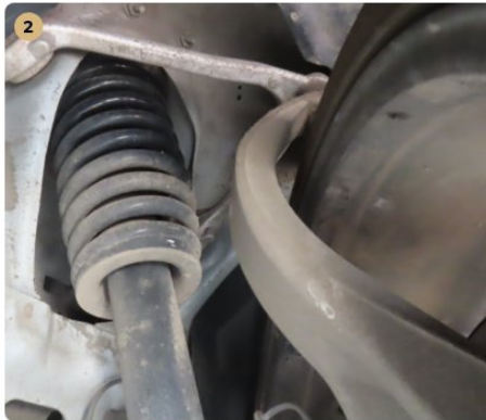
2 Futómű A lengéscsillapítón olajfolyás nem észlelhető.
