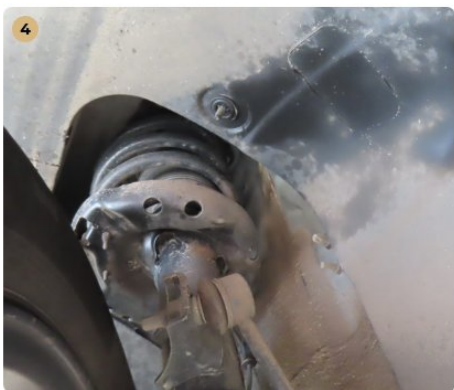
4 Futómű A lengéscsillapítón olajfolyás nem észlelhető.
