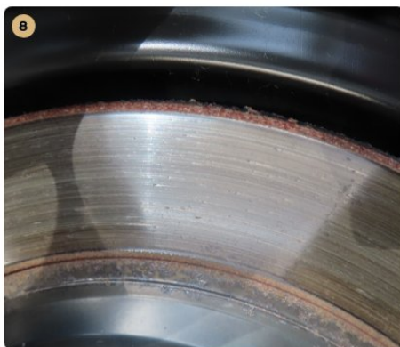
8 Fékrendszer A féktárcsán kezdődő vállasodás található.
