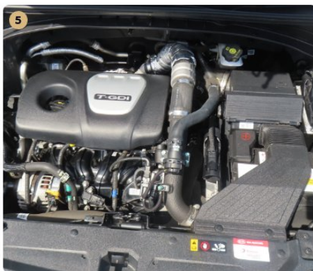
5 Motor Motortérben olajfolyás nem látható.
