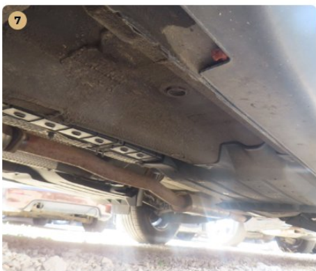
7 Utascella és gyűrődő zónák A küszöbökön javításra utaló nyomok nem észlelhetők.
