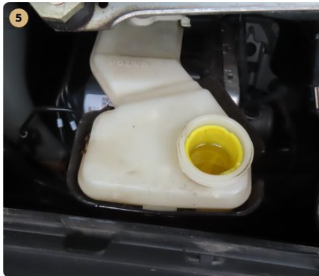
✓ Fékrendszer A fékfolyadék színe megfelelő.
