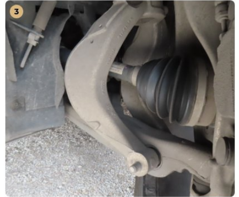
✓ Futómű A féltengelyen zsíros / olajos kicsapódás nem látható.
