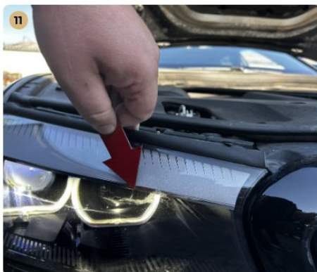
11 Világítás Jobb első fényszórón horzsolás van.
